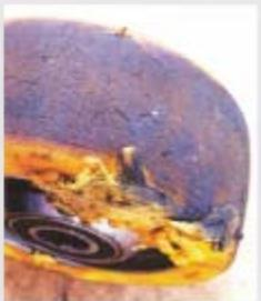
An diesem Polyurethanrad traten Verschleißerscheinungen durch Verfüllung des Materials auf.
